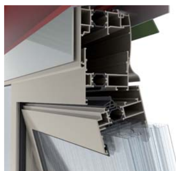
PROFILI A TAGLIO TERMICO L'utilizzo dei nuovi profili perimetrali a taglio termico, garantisce una perfetta tenuta agli agenti atmosferici evitando la dispersione di calore
